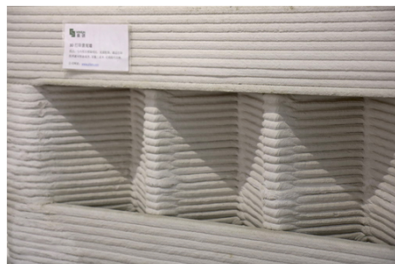
↗ Einzelne, gedruckte Schichten werden zur tragfähigen Wand.
